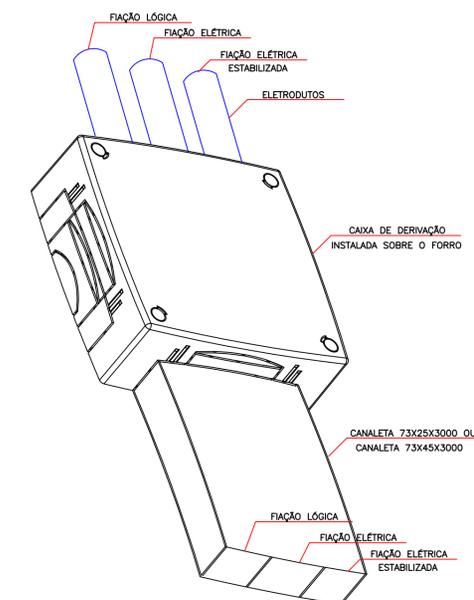
OBS: PARA A CANALETA DE 2 SEPTOS COLOCAR FIAÇÃO ELÉTRICA COM FIAÇÃO ELÉTRICA ESTABILIZADA EM UM SEPTO E FIAÇÃO LÓGICA NO SEGUNDO SEPTO.
