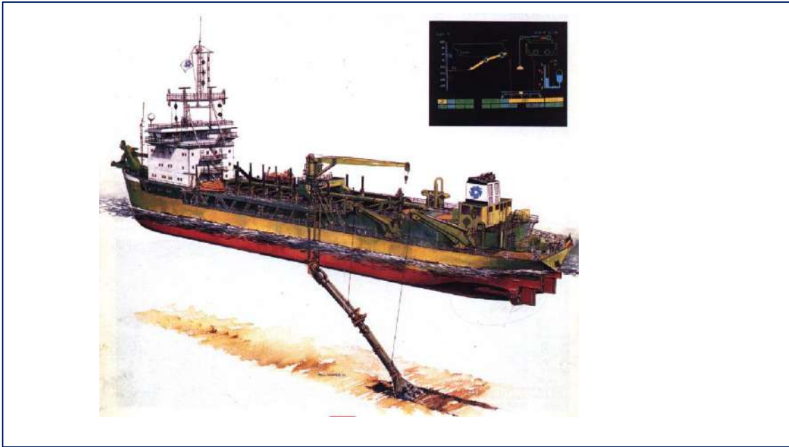
Figura 18: Draga Hopper em processo de dragagem
