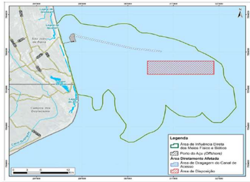
Figura 10 – Definição das ADAs no EIA elaborado para a dragagem de aprofundamento do Porto do Açú. Observa-se que a área de bota-fora oceânico (despejo) é precisa e formalmente declarada como ADA.
