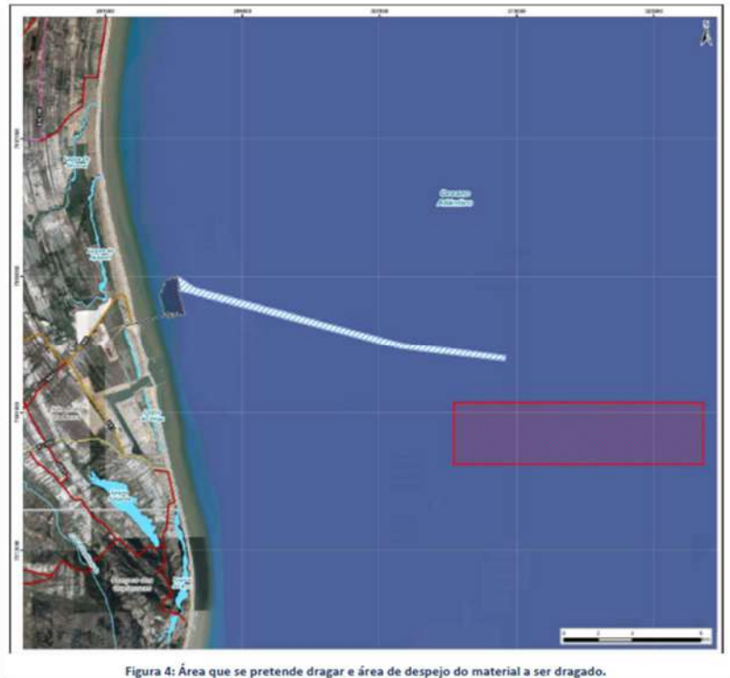
Figura 10 – Definição das ADAs no EIA elaborado para a dragagem de aprofundamento do Porto do Açú. Observa-se que a área de bota-fora oceânico (despejo) é precisa e formalmente declarada como ADA.
