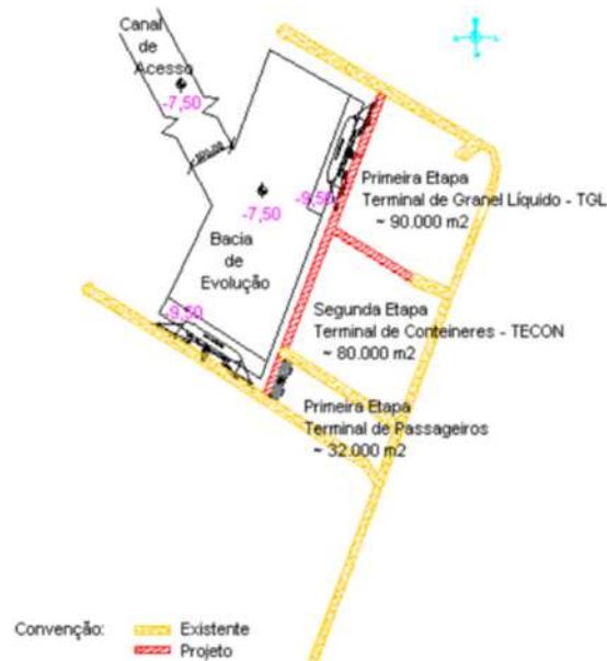
Figura 1 – Figura constante da página 14 do Anteprojeto de Dragagem prevê a instalação de estruturas portuárias na região do molhe existente. Tais estruturas seriam construídas com complementação dos molhes e aterro hidráulico .
