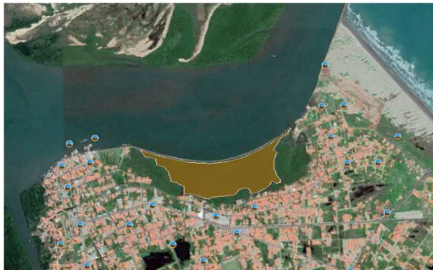
Figura 4 – Área alagadiça próxima ao TLPC que poderia receber materiais dragados para execução de aterro hidráulico.
